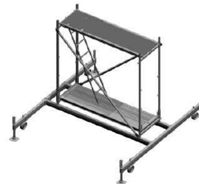
Rys. 47. Kompletna dolna kondygnacja ramowego rusztowania przejazdne typ „Termosprzęt” w wersji z dużym podwoziem
