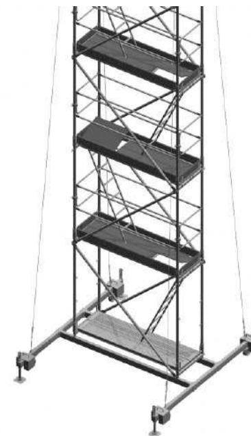
Rys. 53. Montaż balastu na ramowym rusztowaniu przejezdnym typ „Termosprzet” nr katalogowy 8012
