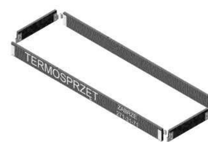
Rys. 49. Zabezpieczenia boczne ramowego rusztowania przejazdne typ „Termosprzęt”: a) poręcz; b) deski burtowe.
