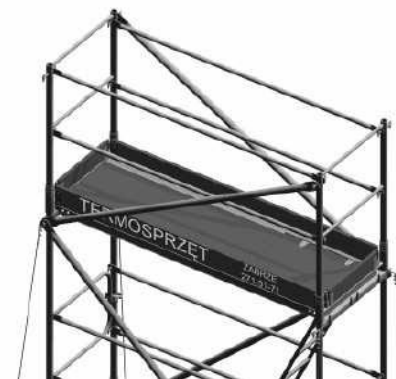
Rys. 52. Najwyższa kondygnacja ramowego rusztowania przejezdnego typ „Termosprzet”
