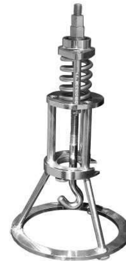
Rys. 57. Przyrząd do sprawdzania zakotwień
